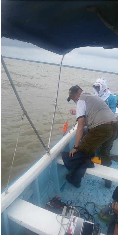
MEDICION DE VELOCIDAD DEL SONIDO CON CTD
